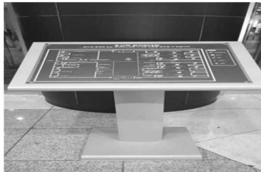
[그림 5] 주출입구에 설치된 시각장애인을 위한 촉지도식 안내판
