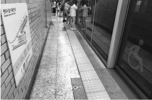
[그림 18] 휠체어 사용자 탑승구역 근처에 설치된 역 이용 안내표지
