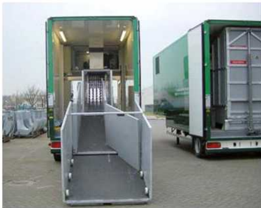
미국형 변형 이동형 가스 안락사 기기 (American Modified Atmosphere Killing) 0.5톤의 시스템으로 한번에 300마리의 유계와 440마리의 닭장 내 산란계를 인도적으로 살 처분 할 수 있음(Thornber·Rubira·Styles, 2014: Fig 1,2)
