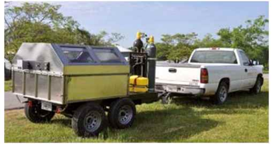
미국형 변형 이동형 가스 안락사 기기 (American Modified Atmosphere Killing) 0.5톤의 시스템으로 한번에 300마리의 유계와 440마리의 닭장 내 산란계를 인도적으로 살 처분 할 수 있음(Thornber·Rubira·Styles, 2014: Fig 1,2)
